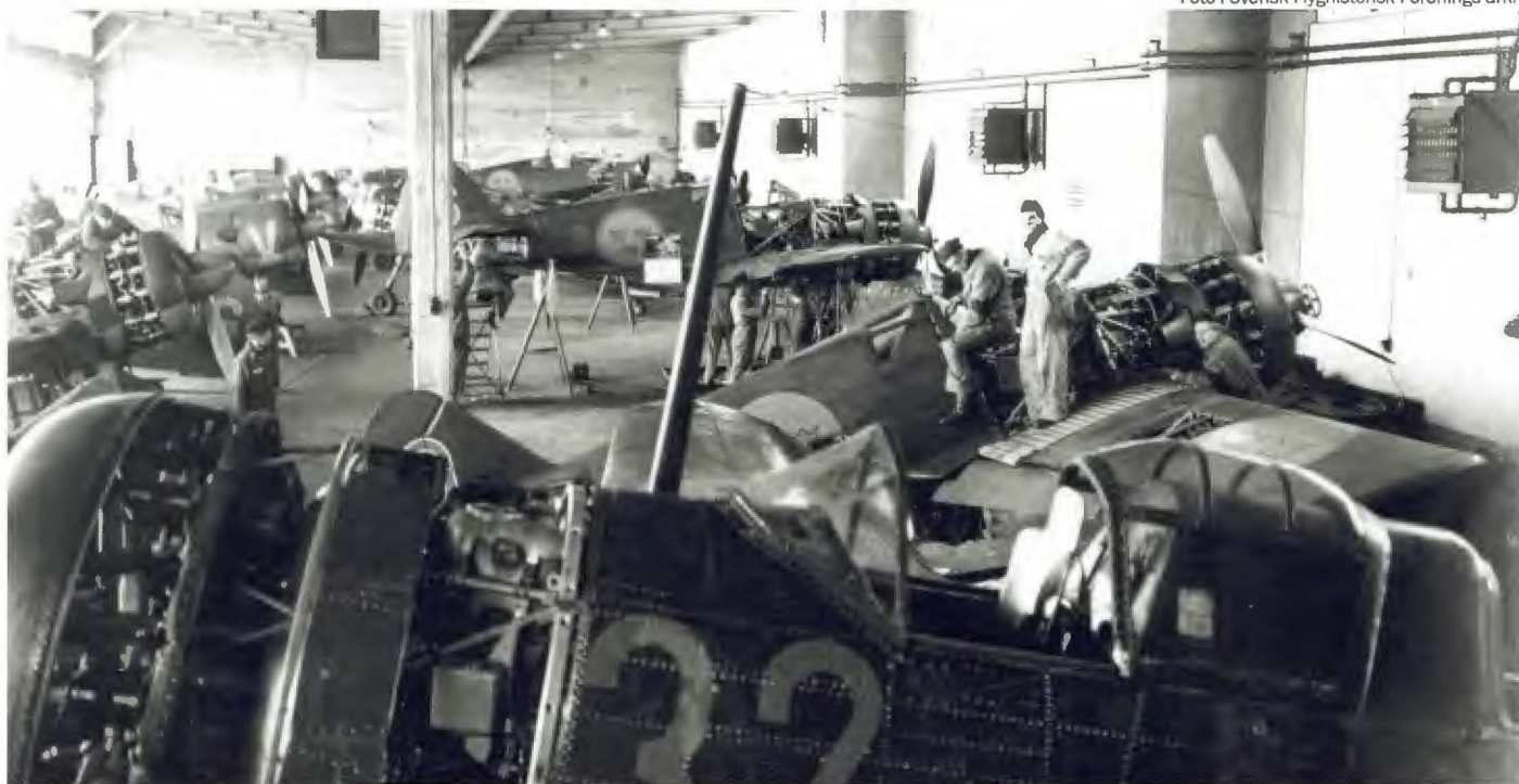
Flottiljverkstaden vid F 8. Närmast en Northrop B 5B och i bakgrunden ett tiotal FFVS J 22.
